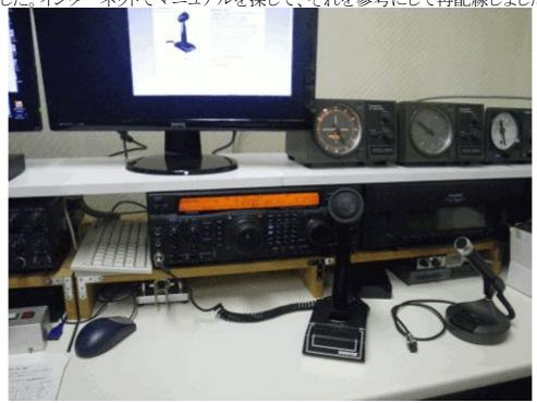
壊れていた VHF/UHF 機の IC-970D を引っ張り出して調子をみました。壊れているのは電源部だけのようです。外付け電源を接続すると動作します。あまり VHF/UHF(144/430/1200MHz 帯)にオンエアすることはないのですが、得した気分になりました。
