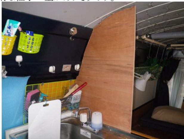
午前中、汗を流したので、午後からはキャンピングカーを改良をしました。流し台の前に壁＝パーティションを設けようという試みです。写真は、切った板をあてがってみたところです。この板に、炊事道具や調味料などを置くための棚を取り付けようと思っています。今日の処は、板を切る所まで完了したので、後日塗装して、取り付けます。
