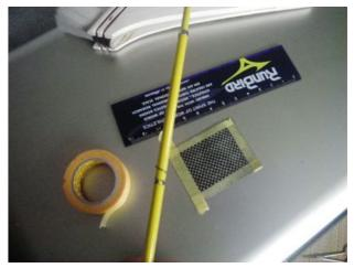
午前中にブドウ園で芽かぎ作業を3時間程していたら、雨が激しく降って来たので家に帰って 昼食にしました。松葉チラシを作ったりして過ごしていると雨も上がったようなので、FRP工作をし ました。ついでに、折れた竿の修理にチャレンジしました。カーボンクロスをネットショッピングで手 配していたので、これにポリエチレン樹脂を含浸させて折れた部分に巻いてやろうという企みです。 カーボンクロスを巻いた上からビニールテープできつく巻きました。明日、取外してみようと思い ます。さて仕上がりはどんなになっているでしょうか???
