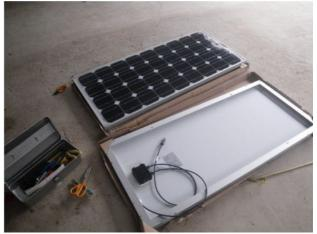
以前ソーラーパネルを購入したのは1年半も前のことですが、同じ商社で同じ型式で販売されていたのは幸いでした。フレームの寸法は全く同じだったので、同じ場所に穴明けすれば良いのです。電気的仕様が若干異なるようですが、大差はなさそうなので問題ないでしょう。現に、パネル表面にヒビが入ったパネルと正常なパネルを直列接続して運転していましたが、バッテリには充電できていたようです。
