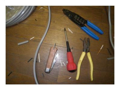
昨年受験した経験から、VVFストリッパーは是非とも持参したい道具の一つです。電工ナイフがあればケーブルを剥くことは可能は可能なのですが、慣れていないものにとっては、ケーブルを剥いたり電線の被服を剥いだりするのに結構な時間がかかってしまいます。ホーザンのP-957というVVFストリッパーを、今年の電気工事士試験のために購入しました。
