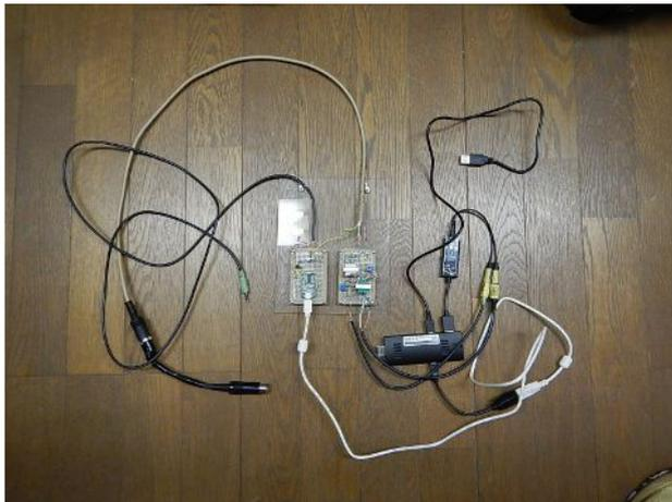
さえない天気の日だったので、新アンテナファームに設置するリモートシャックの動作確認をしました。写真(右上)はスティックPCと無線機を接続するためのインタフェースやハーネスです。色々手直しがあつたりしたので一日中遊べました。ローカルフレンドのかんちゃんとはVoIPの動作確認を兼ねて7MHzで1時間ほどラグチュウして使いものになりそうだという実感を得ました。VoIPにはMumbleを使用しています。スティックPC(Winodws10)にMumbleサーバーをインストールしようかと思ってトライしましたが、Windows版のMumbleサーバーは有償のようなので、過日Raspberry Pi 2(ARM 4 core)にインストールしたMumbleサーバーを使うことにしました。送受信の音声品質は十分実用に耐えそうです。
