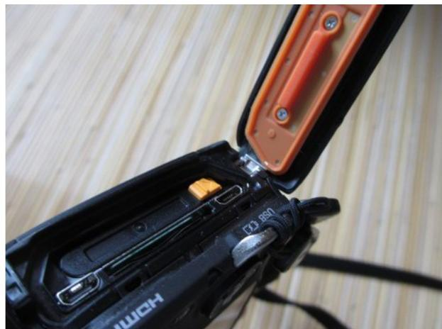
一方、FUJIFILMのXPは同じようなメカなのですが、ヒンジのところにコイル状のバネが仕込んであって、ロックしないと蓋がべろ〜んと開いて異常に気付くようになっています。
