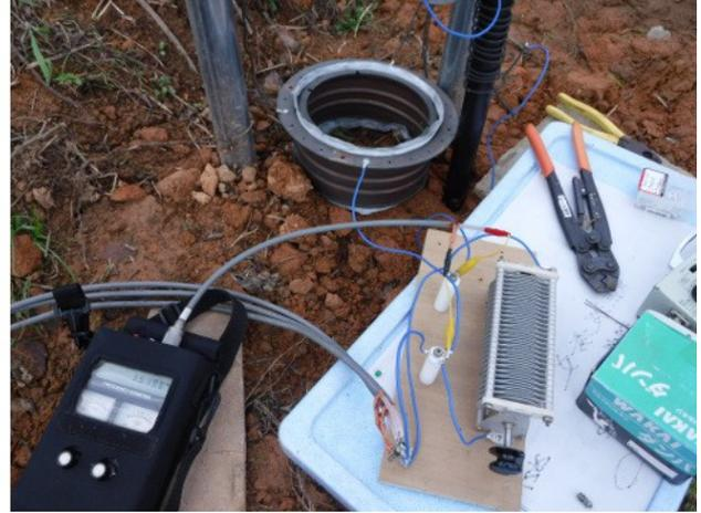
アンテナの同調周波数が3.64MHz位にあってキャパシティブなインピーダンスなので、まず、アンテナと直列にLを入れて、Cでアースに落とし、Cの両端から給電します。シミュレーションの結果から、Lは数 $\mu\text{H}$ 、Cは500pF前後の筈です。Lとして直径約30mmのポリエチレンパイプに $\phi 1.6\text{mm}$ のIV線を2m巻いたものを用意して、それを延ばしてインダクタンスを調整しました。Cは1mの長さに切った5D-2Vを3本並列にしたものと容量不明のバリコンを並列してマッチングを取りました。調整の結果3.5MHzのバンド(3500~3575kHz)が全部SWR1.2以下に収まることを確認しました。中心周波数は3540kHz付近で、ここでのSWRはほぼ1.0でした。
