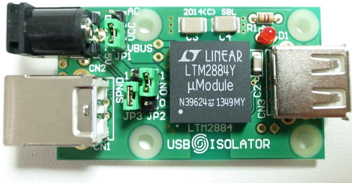
この手の高周波の回り込みの原因は、コモンモードノイズによるものだと考えられます。周波数が低いコモンモードノイズに対しては、DC 的な絶縁が効果があります。医療や産業用途の微小信号を扱う電子装置では、50/60Hz の商用電源の回り込みを避けるために、信号をアイソレーションするのが常識です。
