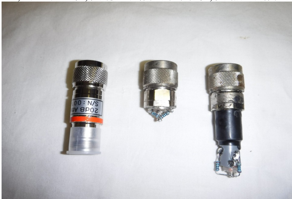
写真は左から 1)アッテネータ、2)改良後の自作終端抵抗器、3)改良前の自作終端抵抗器
