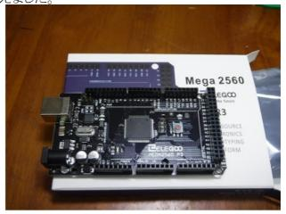
M5STACK を Amazon でポチッとして買うとき、ついつい広告に引き込まれて、ELEGOO MEGA2560 R3 なるものもついでに買ってしまいました。従来の Arduino に GPIO やシリアル IO が増量されたものです。これなら、I2C などで GPIO を増やさなくても十分すぎる量だと思います。ちなみに、Arduino を使って製作した山の上のリモートコントローラで、GPIO が足りなくて困っていたところです。、従来の Arduino ではデジタル入出力 20、アナログ入力 6、シリアル 1 ポートですが、MEGA 2560 ではデジタル入出力 54、アナログ入力 16、シリアル 4 ポートなって、倍以上に増えています。とは言え、寸法的には長手方向が 3cm 程長くなっているだけなので、IO 数を多く必要とするアプリには最適です。
